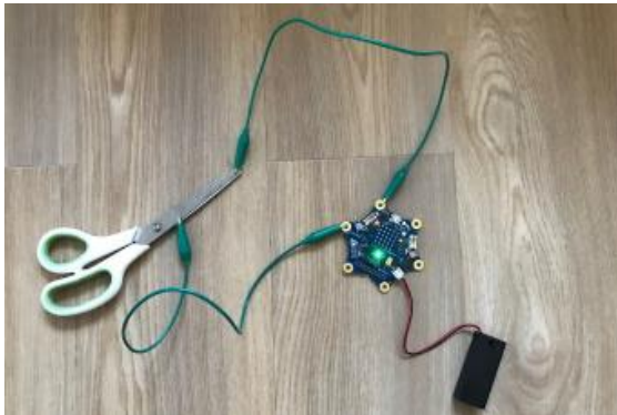
Abbildung 3: Der Calliope als Leitfähigkeitsprüfer
