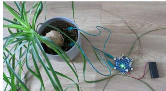
Abbildung 5: Der Calliope als Gießhilfe
