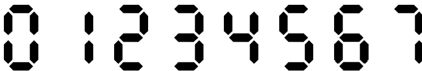
Abbildung 2: Darstellung der Ziffern 0 bis 7 in der Siebensegmentanzeige
