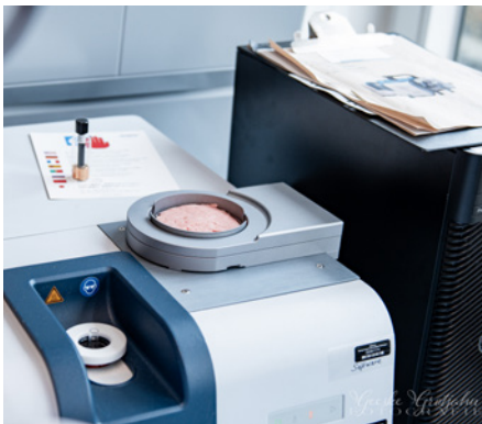
Im NIRS wird das Fleisch auf seine Rohnährstoffe analysiert.
