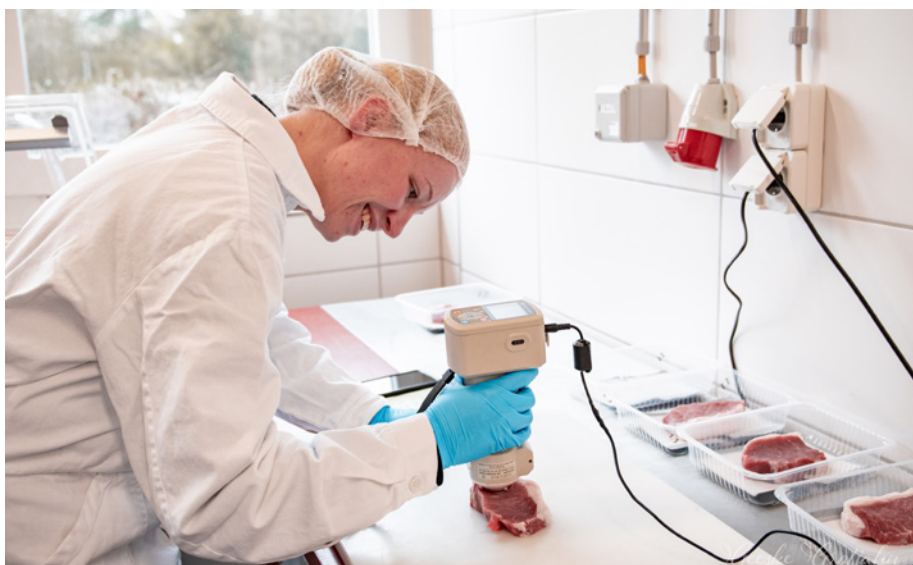
Im Labor der Uni Göttingen wurde die Farbe des Fleisches an jeweils 6 Stellen gemessen.
