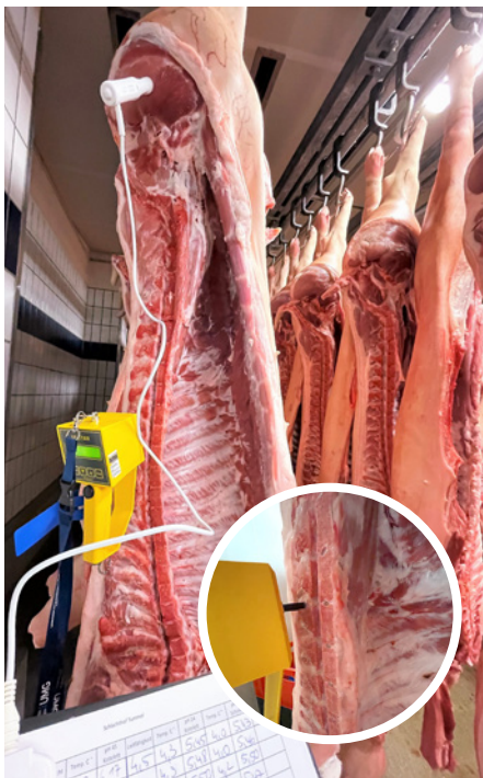
Der pH-Wert und die Temperatur wurden nach 45 Min zwischen der 13. und 14. Rippe der linken Schlachthälfte sowie im Schinken gemessen.
